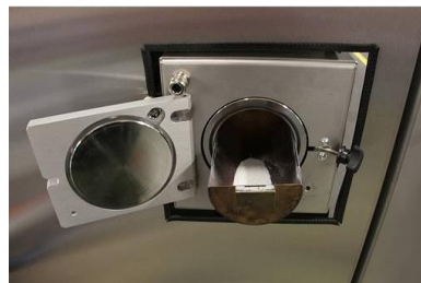
P260 laitteen höyrystinkammio jauhemaisen Dimeerin syöttöön
