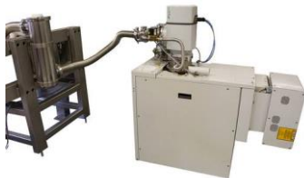
Jäähdytin ja alipainepumppu
